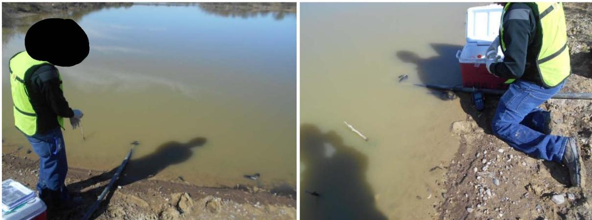
**Fotografías 8.1.2.4-7 a 8.1.2.4-8.-** Toma de muestra de agua y Determinación de pH, in situ.
