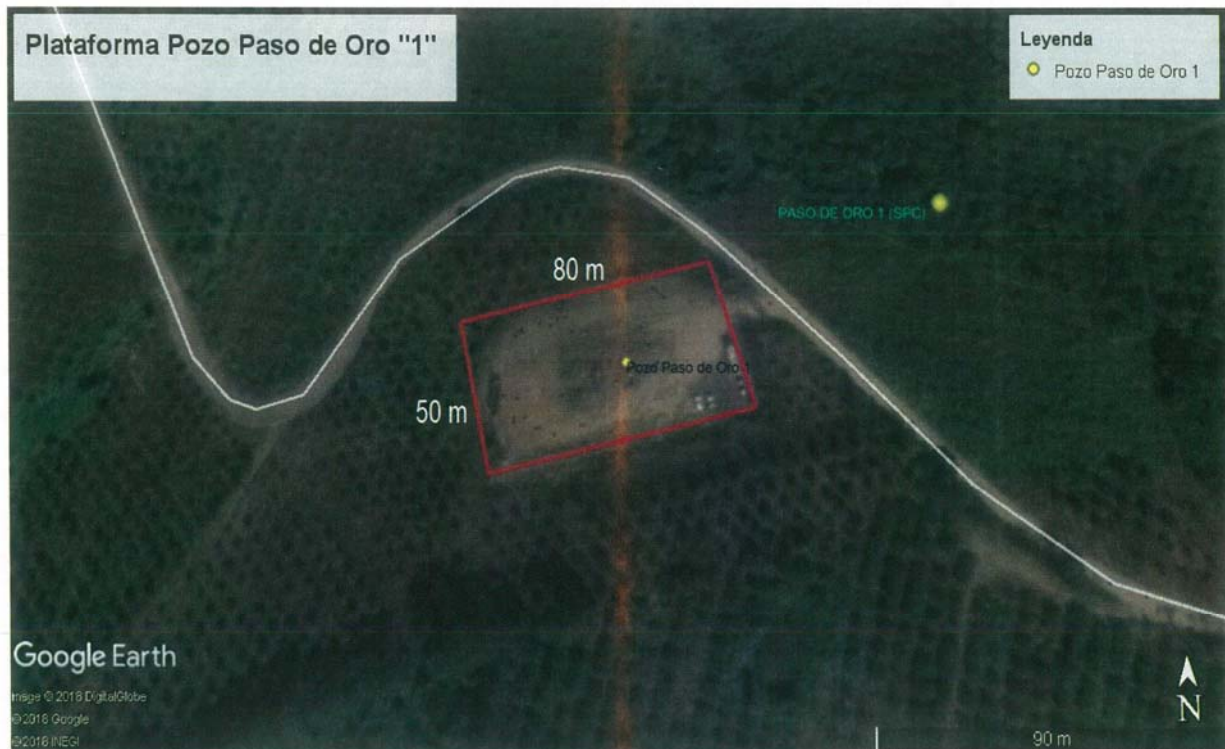
Figura 2. Delimitación de la plataforma del pozo Paso de Oro 1.
