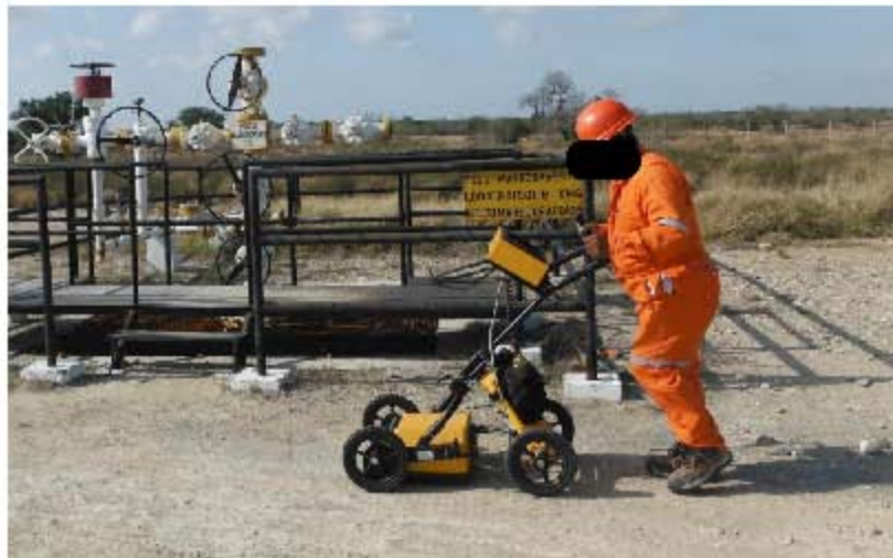
Fotografía 20. Escaneo con geo-radar USRadar P-0500
