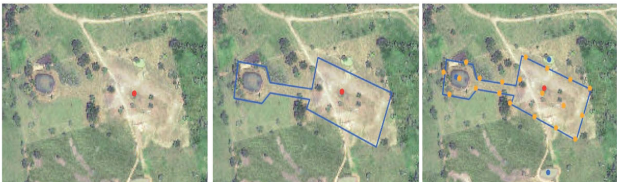
Fig. VI.6. Delineación del área de influencia en pozos petroleros para la toma de muestras de suelo. Ubicación de la válvula del pozo (punto rojo), delimitación de la plataforma de perforación (línea azul) y ubicación de los puntos de muestreo (puntos naranja). Las coordenadas geográficas de los puntos pueden verse en el Anexo VI.3
