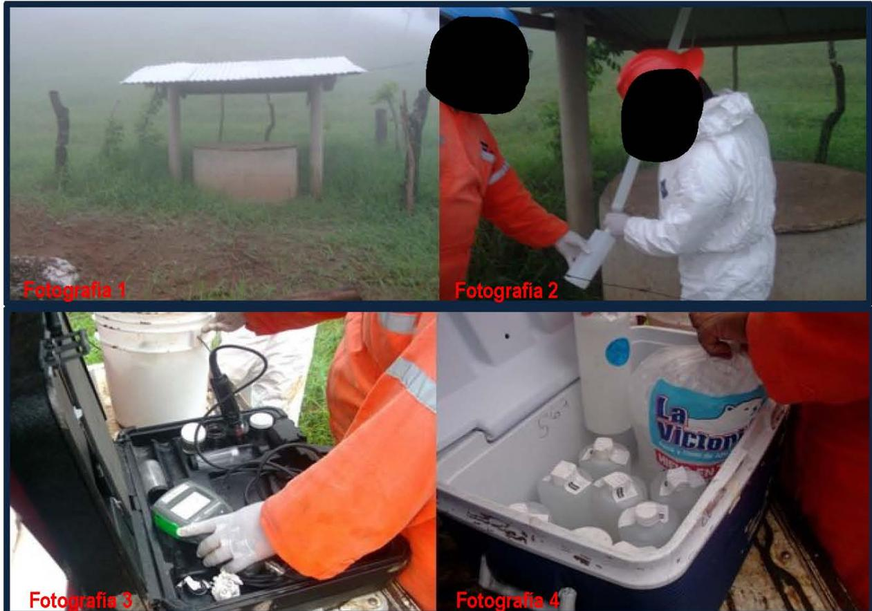
Fotografía 8.1.2.4-6.- Pozo de agua. Fotografía 2 Toma de muestras de agua. Fotografía 3 Pruebas *in situ*. Fotografía 8.1.2.4-6 Conservación de muestras.
