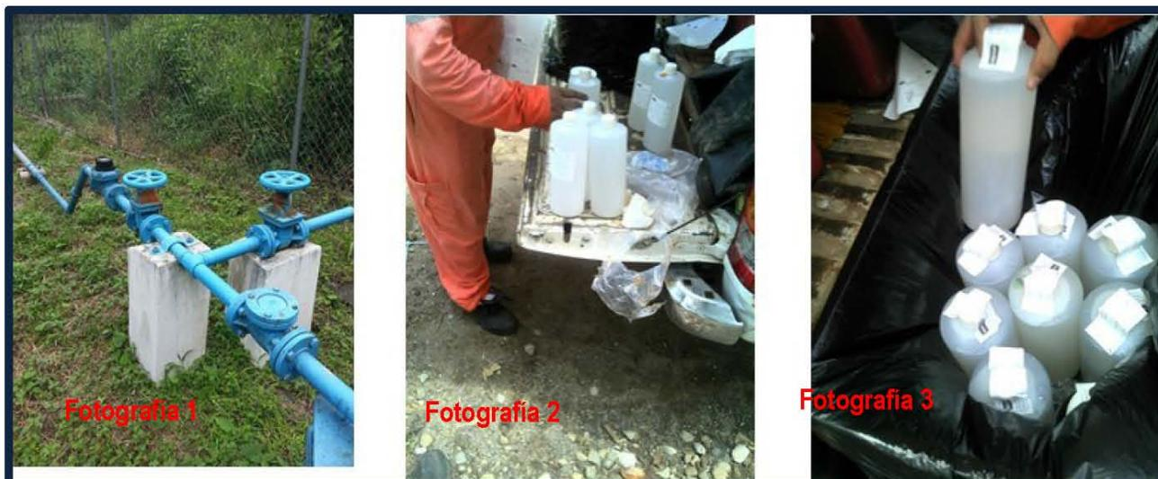
**Fotografía 8.1.2.4-7.-** Pozo de agua muestreado. Fotografía 2 Toma de muestras de agua y pruebas *in situ*. Fotografía 3 Envasado, etiquetado y conservación de muestras.
