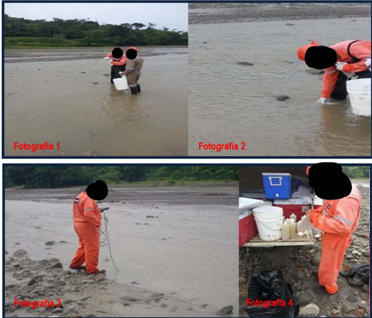
Fotografía 8.1.2.4-2.- Río Ostucán, muestreado. Fotografía 2 Toma de muestras de agua. Fotografía 3 Análisis *in situ*. Fotografía 4 Envasado, etiquetado y conservación de muestras.
