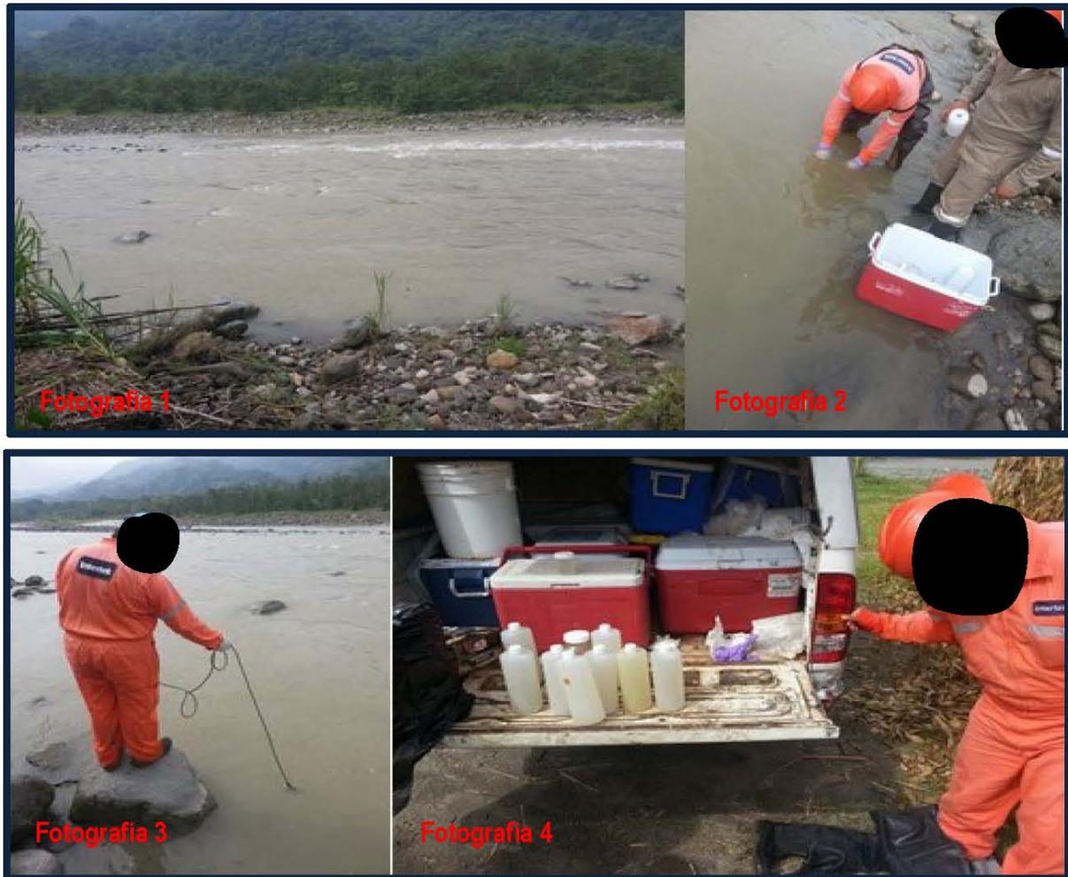
Fotografía 8.1.2.4-1.-Río Ostucán muestreado. Fotografía 2 Toma de muestras. Fotografía 3 Análisis *in situ*. Fotografía 4 Envasado, etiquetado y conservación de muestras.
