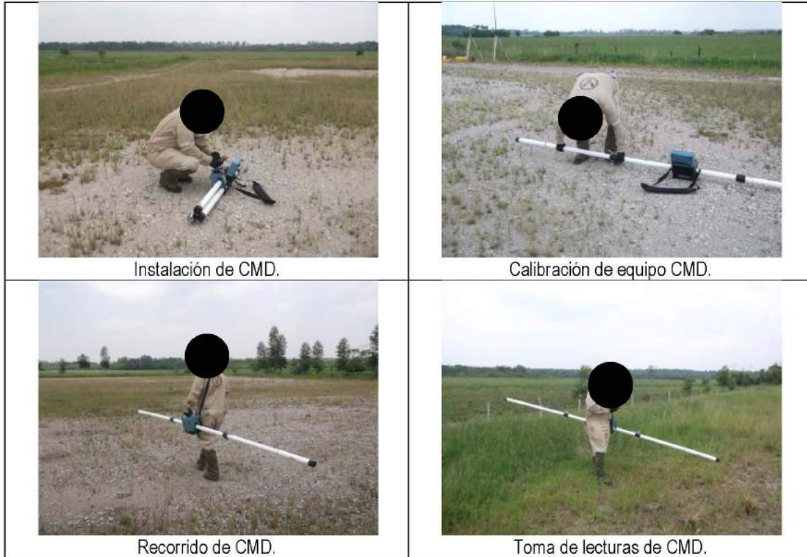
Fotografía 8.4.2-10.- Ejecución de los trabajos de perfil electromagnético.
