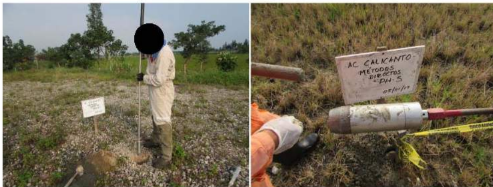
Fotografía 8.4.3-2. Uso de equipo de extracción de muestras, martillo de pistón y tubo nucleador.
