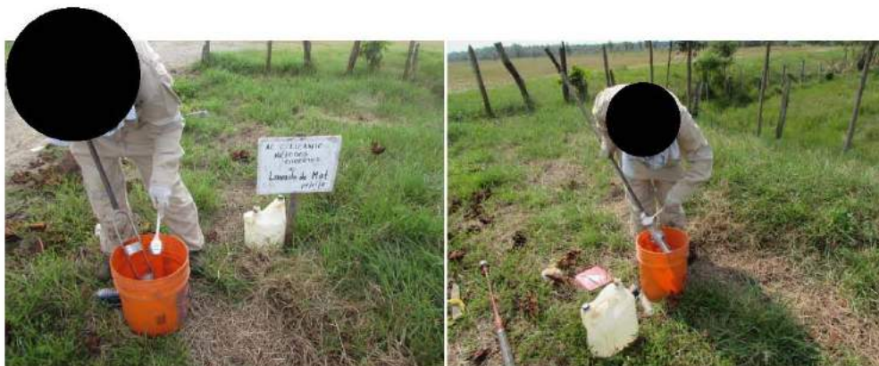
Fotografía 8.4.3-4. Lavado del equipo Hand Auger que se utiliza para la extracción de muestras de suelo.
