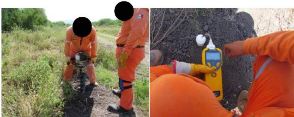
Fotografía 8.4.2-4.- Instalación Gasometrías y lectura de compuestos orgánicos volátiles acumulados en el tubo de Gasometría. (ejemplo tomado en Cd. Victoria, Tamaulipas.)
