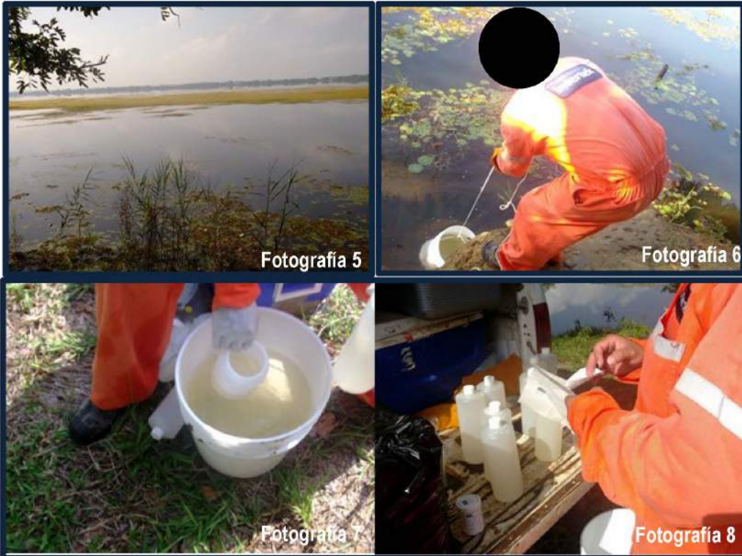
Fotografía 8.1.2.4-5 a 8.1.2.4-8.- 5. Cuerpo de agua muestreado. 6. Toma de muestras de agua. 7. Envasado de muestras. 8. Etiquetado y análisis in situ .
