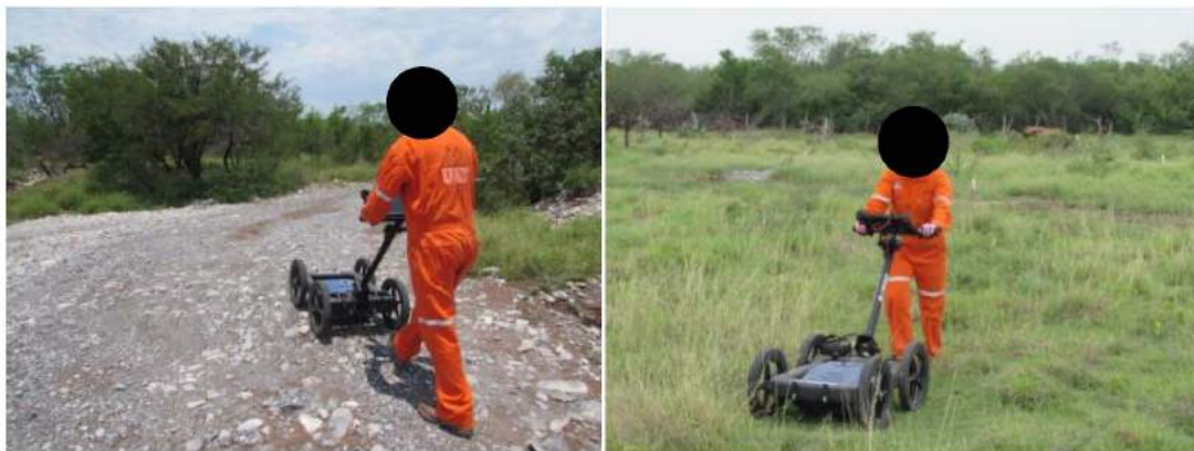
Fotografía 8.4.2-4.- Georadar marca Quantum Imager Triple Frequency Stepped Pulse System. (Ejemplo tomado en Cd. Victoria, Tamaulipas).
