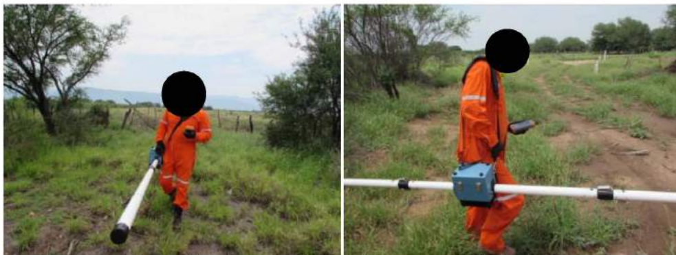
Fotografía 8.4.2-2.- Medidor de Conductividad Electromagnética (CMD) (Ejemplo tomado en Cd. Victoria, Tamaulipas).
