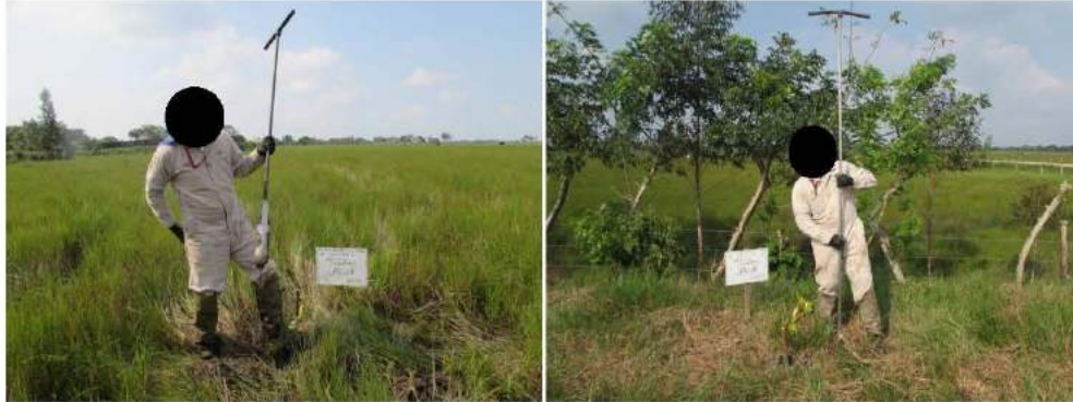
Fotografía 8.4.3-1. Equipo de perforación manual (Hand Auger).
