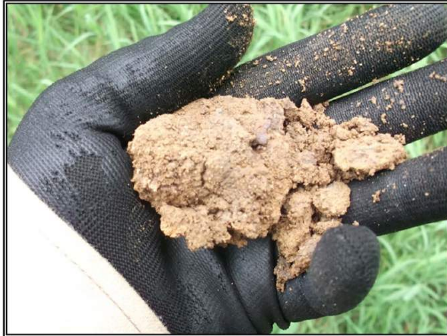
Fotografía 8.4.1-24.- Inspección de la muestra en busca de partículas indicio de material contaminado.
