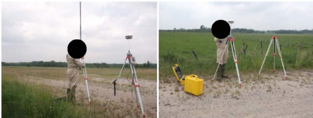
Fotografía 8.4.2-13.- Trabajos de levantamiento Topográfico con estación GPS Topográfico Marca South Modelo RTK-S82T.
