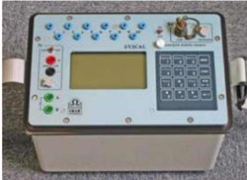
Figura 8.4.2-4.- Resistivímetro SYSCAL Pro. Switch 24.
