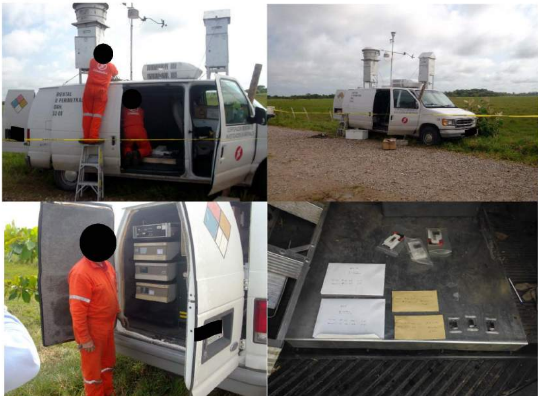
Fotografía 8.1.2.1-1.- 1. Montaje de la unidad de monitoreo. 2. Equipo instalado. 3. Verificación del funcionamiento de los analizadores. 4. Identificación de los filtros y unidades de almacenamiento de datos.
