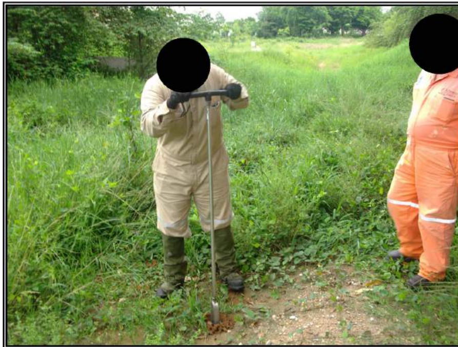
Fotografía 8.4.1-16.- Ejecución de sondeos en el área cercana al terraplén del pozo Calicanto 101.
