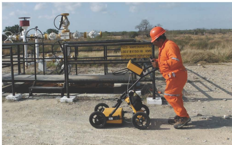
Fotografía 20. Escaneo con geo-radar USRadar-P-0500
