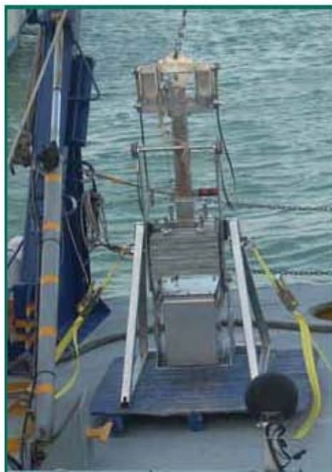
Figura 5.6 Boxcore de corte cuadrado utilizado en el muestreo de sedimento
