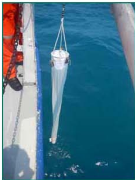
Figura 5.7 Red estándar de 20 \mu\text{m} empleada para la colecta de muestras de fitoplancton
