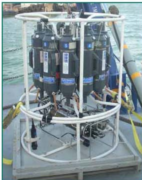
Figura 5.5 Roseta de botellas Niskin utilizada en el muestreo de agua
