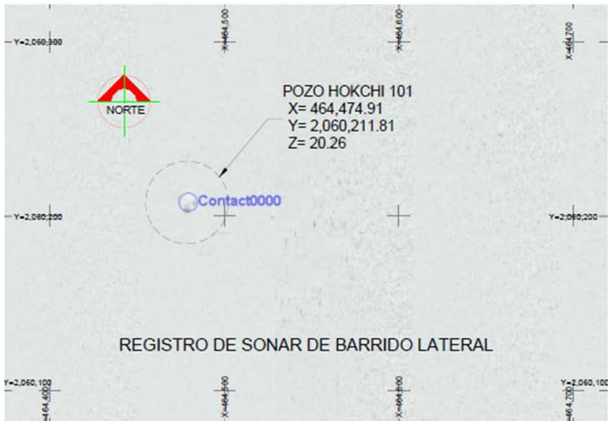
Figura 7.7. Imagen de sonar de barrido lateral donde el círculo indica la posición del pozo Hokchi-101 y la anomalía central corresponde a su ubicación.
