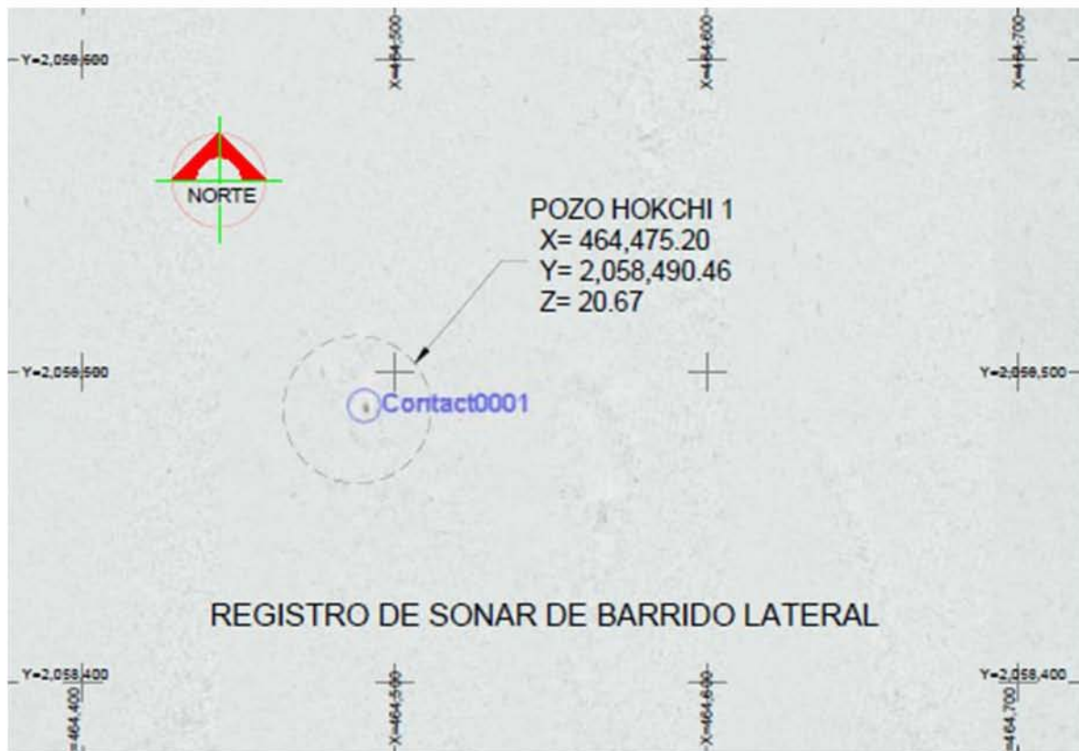
Figura 7.4. Señal registrada por el sonar de barrido lateral donde el círculo indica la posición del pozo Hokchi-1 y la anomalía referida como Contac001 corresponde a un objeto sobresaliendo sobre el lecho marino.
