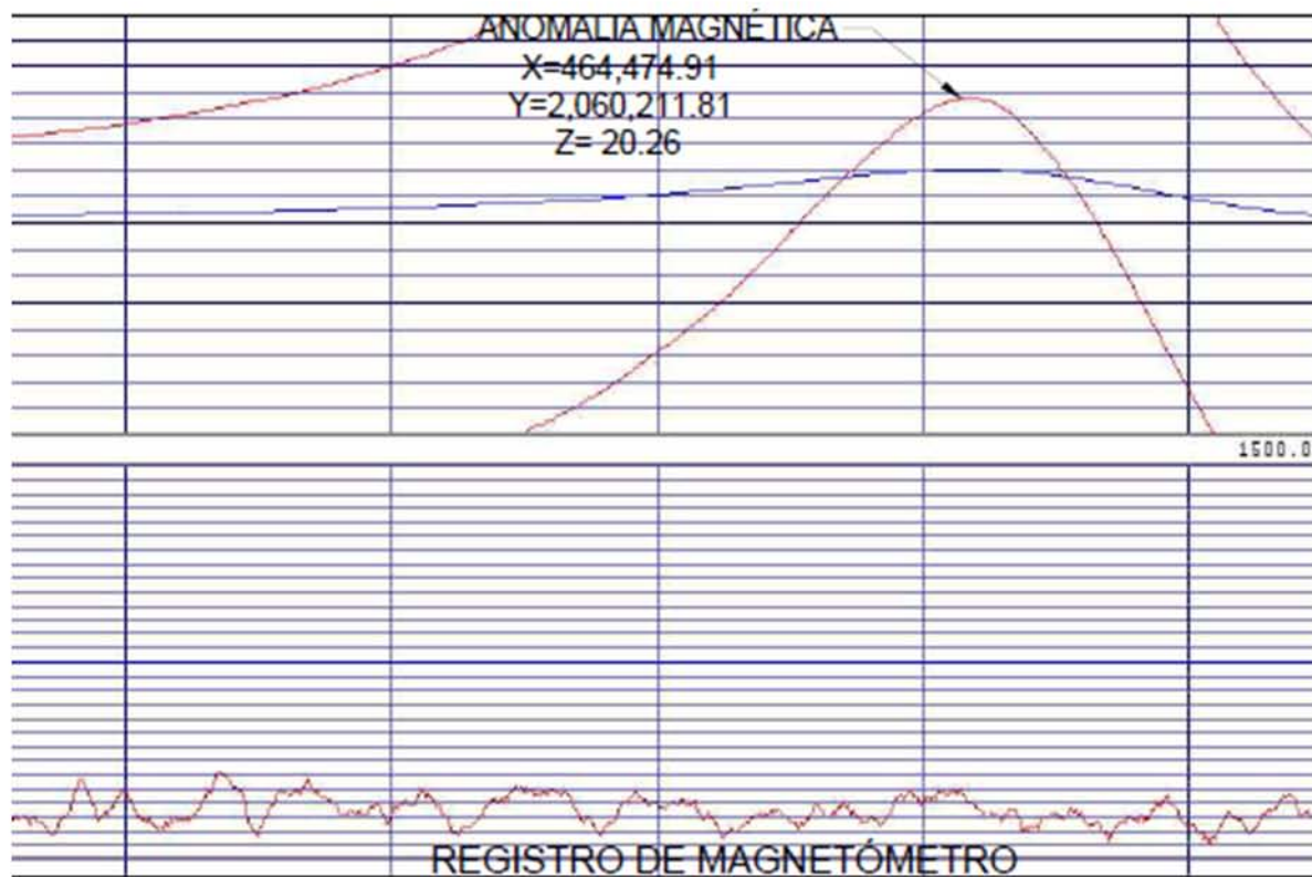
Figura 7.9. Anomalia magnética asociada a la tubería de revestimiento por arriba del lecho marino en el Pozo Hokchi-101.
